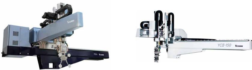
プラスチック成形品のおよそ2/3が、「射出成形」という工程で作られています。高温で溶かしたプラスチックを金型に注入した後、冷却して成形品を製造します。この金型からプラスチックを取り出す専用ロボットのことを「取出口ボット」と呼んでおり、多くの射出成形機に搭載されています。取出口ボットは、スマートフォン内部の小型部品から自動車バン
